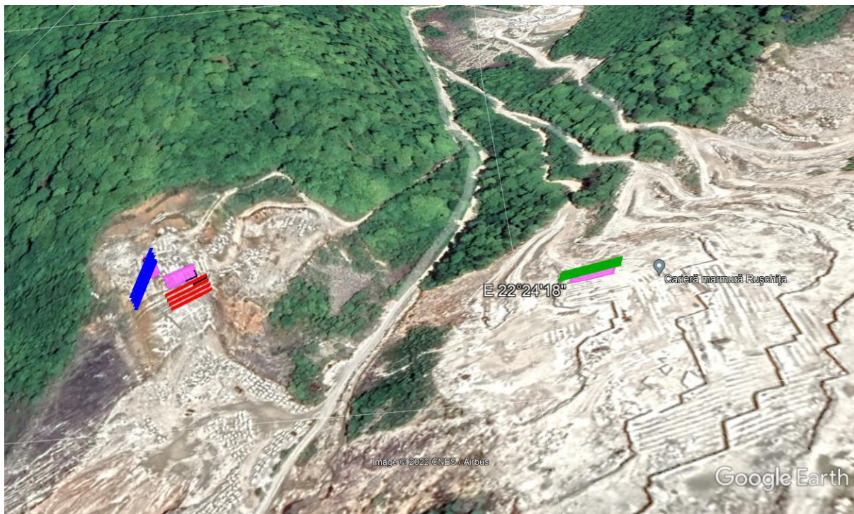
Fig.1 – Cariera Rușchița și localizarea profilelor geofizice de măsurători în Google Earth (roz-GPR; roșu și albastru – electrometrie; negru-seismică; verde-magnetometrie).
