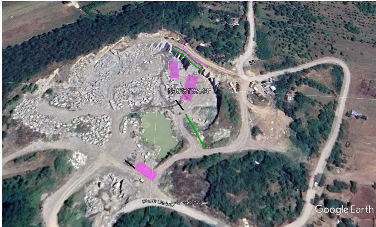
Fig.2 – Cariera Cărpiniș și localizarea profilelor geofizice de măsurători în Google Earth (roz-GPR; verde – electrometrie; negru-seismică).
